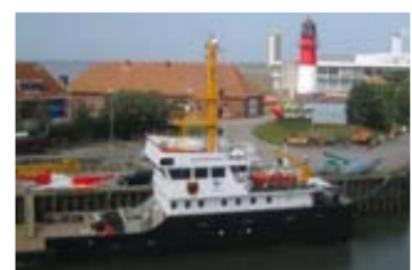
Eines der größten Schiffe im Büsumer Hafen ist die „Triton“, das Flaggschiff des Wasser- und Schiffahrtsamtes Tönning. Das knapp 50 m lange Schiff dient zum Auslegen, Einholen, Transportieren und Bearbeiten von Seezeichen (Tonnen). Es übernimmt aber auch Materialtransporte, Verkehrssicherungsaufgaben, Hindernisbergung oder Hilfsdienste bei Havarien. Gelagert und ge-wartet werden die Seezeichen auf dem Tonnenhof 2/E am Leuchtturm [→10].
